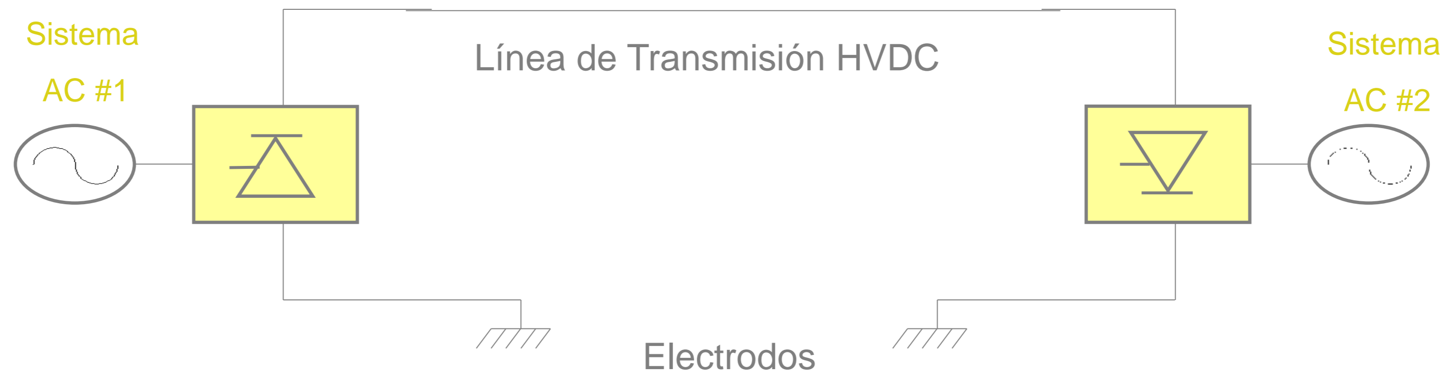
Enlace Monopolar con retorno por tierra
